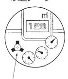
蛇口を全部閉めて パイロットを見 ます。パイロッ トが回っていれ ば漏水です。
